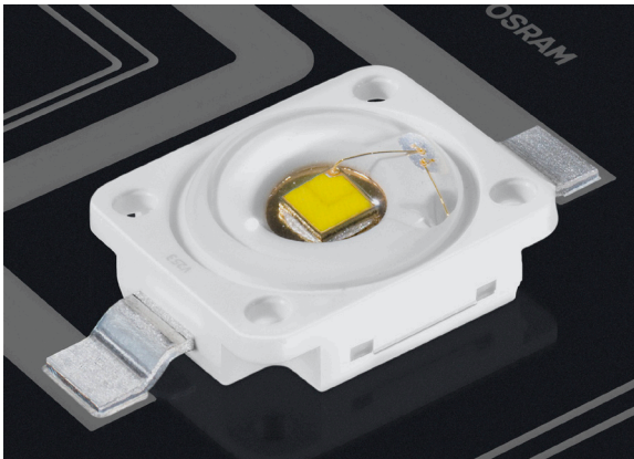
Weisse LED Raumleuchte von Osram. Gut erkennbar ist die gelbe Phosphorschicht, mit der das blaue LED-Licht in weisses transformiert wird.
