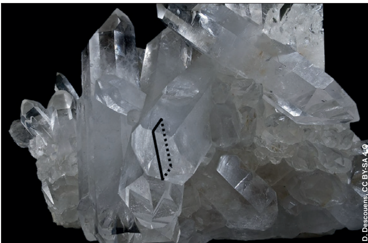
Abb. 1: Quarzkristall (Bergkristall) aus Minas Gerais (Brasilien) mit eingezeichnetem Quarzplättchen, das in Längsrichtung piezoaktiv ist. (Ausschnitt aus Gesamtbild)
