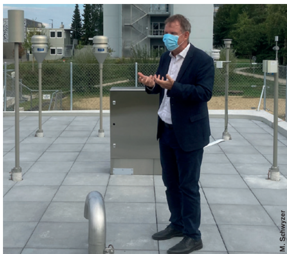
Lukas Emmenegger, Leiter Luftfremdstoffe und Umwelttechnik, demonstriert die auf dem Dach der Messstation angebrachten Ansaugleitungen zur Messung der Luftqualität. Die beiden pilzförmigen Probenahmen scheiden Feinstaubpartikel verschiedener Grösse ab und führen den Rest der Luftprobe den direkt darunterliegenden Analysegeräten zu. Andere Röhren dienen der Analyse gasförmiger Luftfremdstoffe.
