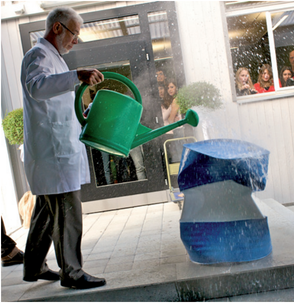
Abb. 1: Demonstration der Wirkung des Luftdrucks anlässlich der Einweihung des Vakuumlabors am Schülerlabor iLab des PSI am 29. Oktober 2010. Das Foto zeigt den Augenblick nach der Implosion des Fasses, die durch einen Knall begleitet wurde. Bild: Markus Fischer, PSI
