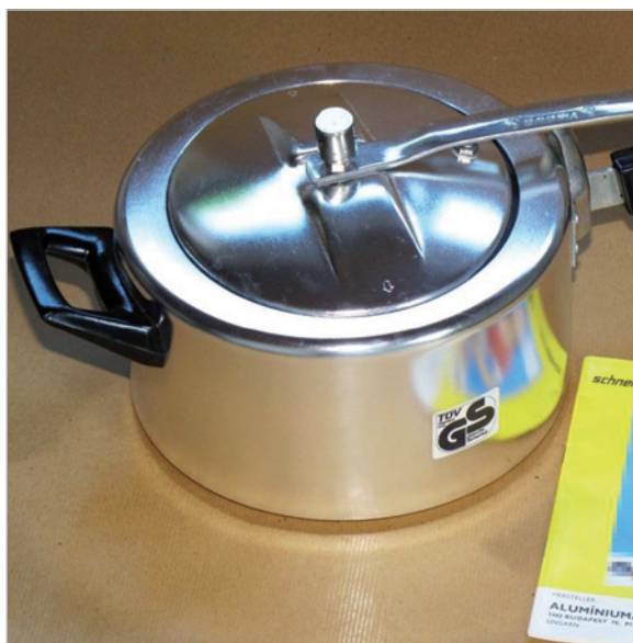
Abb. 2: Dampfkochtopf der 1960er Jahre mit von innen her schliessendem Deckel. Der gekrümmte elastische Bügel wird rechts am Henkel der Pfanne mit einer Schnalle fixiert. Damit der Deckel in die Pfanne eingeführt werden kann, biegt er sich in Ruhelage leicht nach unten. Bild: Michael Nebel, Wikipedia CC BY-SA 3.0
