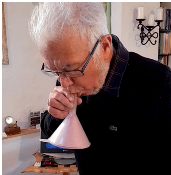
Abb. 3: Trichterexperiment als Paradebeispiel für das Bernoulli Paradoxon. Es gelingt nicht, den violetten Papiertrichter aus dem Plastiktrichter hinauszublases. Würde man ein Gebläse an den Trichter anschliessen, könnte man sogar Gewichte an den Papiertrichter anhängen, ohne dass dieser nach unten fällt. Bild: Sofia Tsintsifa
