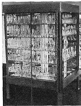
Abb. 3. Lichtschrank für Algenkulturen bei geöffneten Türen.
