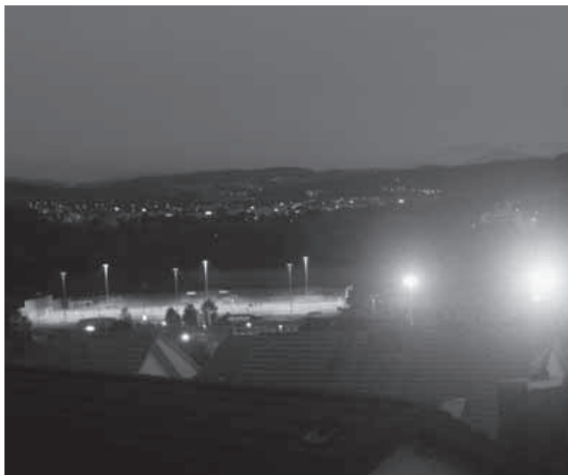
Abb. 3 Sportplatz in Geroldswil (Kanton Zürich). 2008 wurde neben dem bestehenden Sportplatz (blendend, rechts) ein zweiter Fussballplatz (links) gebaut. Dank Intervention von Dark-Sky Switzerland wurde in Zusammenarbeit mit den Behörden und Installateuren der Fehler aus früheren Jahren nicht wiederholt. Die neue Beleuchtung erfreut Spieler durch gleichmässiges Licht auf dem ganzen Feld und Anwohner durch die ausbleibende Blendung gleichermassen.
