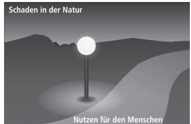
Abb. 1. Kugellampe. Während das Licht bei einer Kugellampe am Boden nutzbringend zur Orientierung verwendet wird, wird es gleichzeitig am Himmel und in Naturräumen verschwendet. Mehr als die Hälfte des erzeugten Lichts strahlt ungenutzt, aber schadhaf in den Nachthimmel. Bei Bodenstrahlern, welche die Blätter von Bäumen beleuchten sollten, ist der Anteil noch höher.
